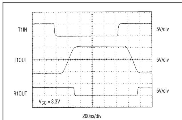
Figure 12. MAX3225E/MAX3227E/MAX3245E Loopback Test Result at 1Mbps
